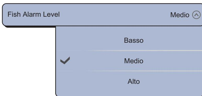
3. Selezionare l'intensità dell'eco che determina il rilascio degli allarmi pesce e blocco fondale.
