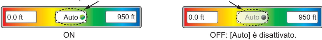
[Valore Minimo]: imposta l'intervallo di profondità minimo per cui visualizzare l'ombreggiatura, con la tastiera software. Questa opzione è disponibile quando [Auto Depth Shading Color Scale] è impostato su [OFF].
